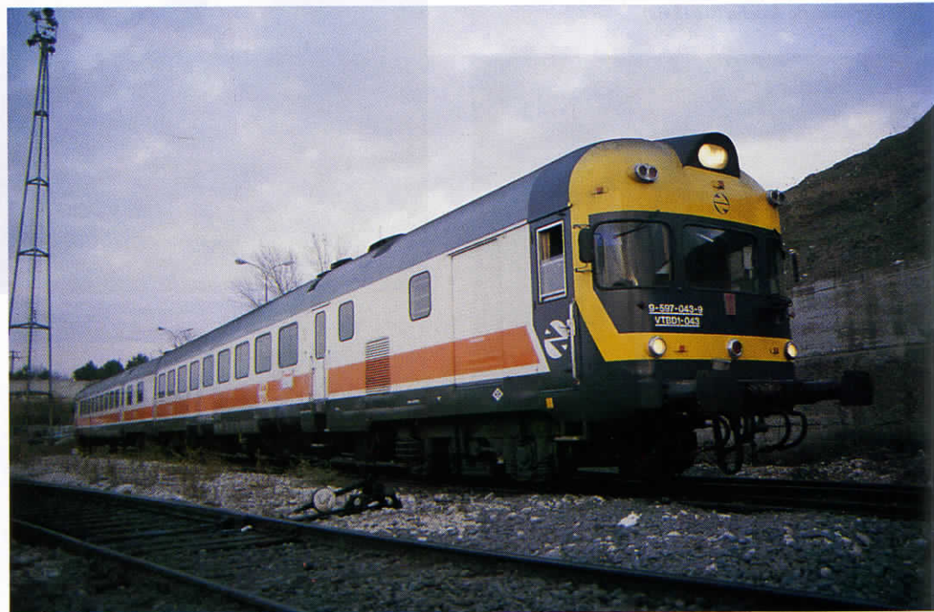
597-043 con el nuevo esquema de pintura a falta de su transformación interior. Falta la sustitución del pequeño furgón de equipajes por el departamento de 1ª clase. Depósito de Cerro Negro (abril/92).
