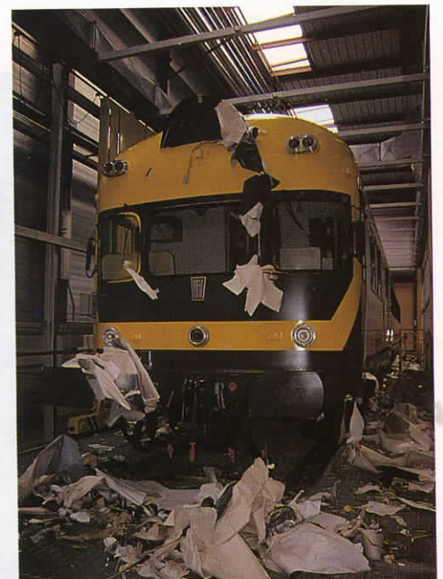
Una vez finalizado todo el pintado del TER 597-011 es preciso retirar los distintos enmascaramientos que se han utilizado para aplicar los colores. Fuencarral (febrero/93).
