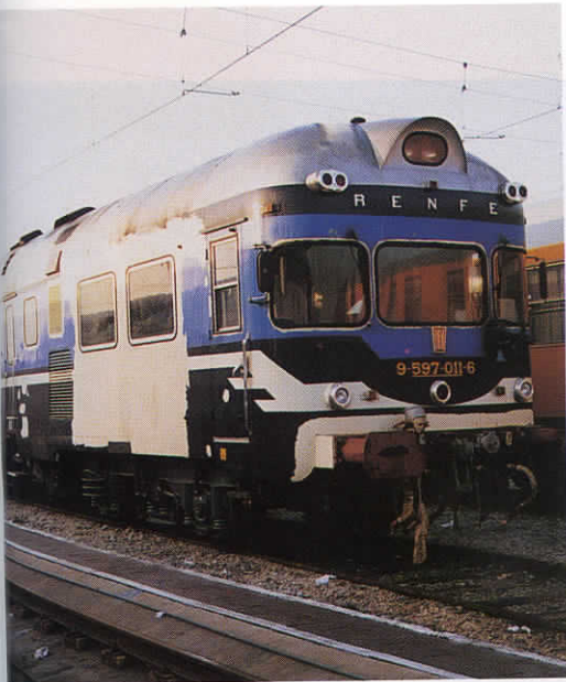
597-011 antes de entrar en la nave de pintura de Fuencarral. El automotor ya ha sido modificado y observar la desaparición de la puerta del furgón y las dos ventanillas del departamento de 1ª clase (febrero/93).
